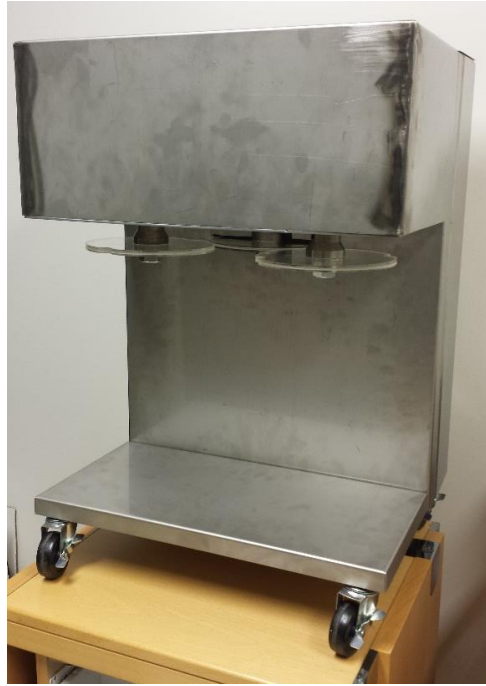
Mynd 19 Átöppunarvél með stálhlífum
