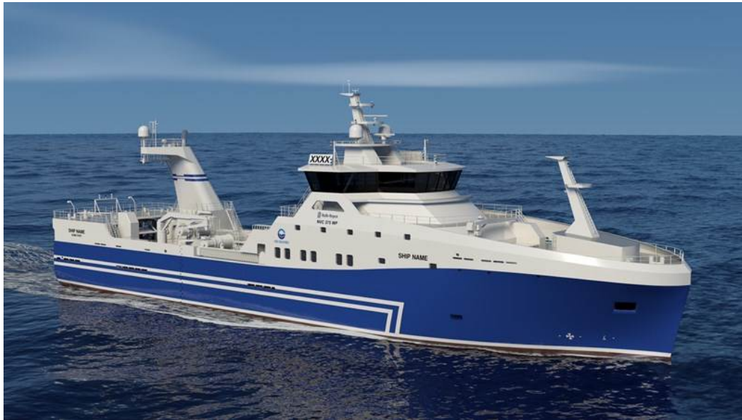
Mynd 8. Teikning af frystitogara HB Granda, 81 m langur og 17 m breiður. Heimild: HB Grandi
