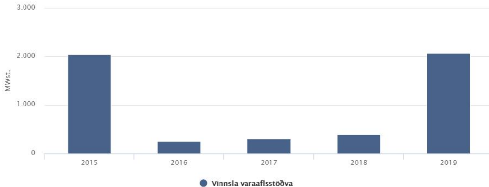
Mynd 3.3: Vinnsla varaafstöðva vegna fyrirvaralausra truflana í flutningskerfi Landsnets síðustu 5 ár[1].
